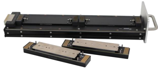
带有在线监测功率的CoC抽屉及夹具支持 LIV 扫描及功率测量
